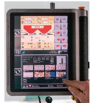
**FIGURA 16.1.5** (a) spandiconcime VRT a doppia girante Vicon Rotaflow RO della ditta Kverneland; (b) particolare delle bilance per misurare la quantità di concime che cade sui due piatti; (c) mappa di prescrizione; (d) esempi di centraline operative sulla cabina della trattrice, rispettivamente il Tellus della Isomatch e l' Autosetapp della Vicon (fonte: [www.ilnuovoagricoltore.it](http://www.ilnuovoagricoltore.it)).
