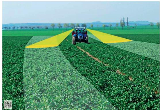
FIGURA 16.1.2 (a) Sistema di rilievo dell'NDVI con sensore (Yara N-Sensor©) posto sul trattore per pilotare la concimazione VRT «on the go»; (b) sensori laterali.
